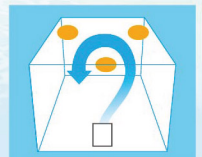
การไหลของอากาศแบบทิศทางเดียว ฟอกอากาศในถึงบริเวณจุดบอด
