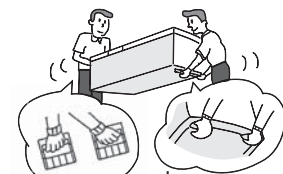
ที่จับตรงช่วงล่าง ด้านในส่วนหน้า ของตู้เย็น ที่จับตรงด้านบน ส่วนหลังของตู้เย็น
